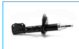
7000481 AMORTIGUADOR DELANTERO GAS "R"
