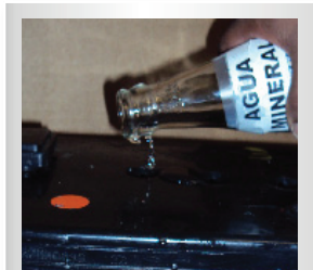
AÑADIR LÍQUIDOS EXTRAÑOS No introduzca líquidos extraños y/o electrolito de dudosa procedencia.
